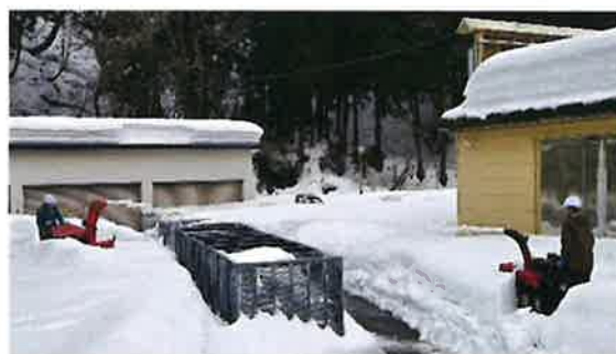
小型除雪機でスチールコンテナに雪を詰めます
