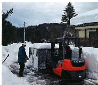
フォークリフトでコンテナを雪室に運び、5列×3段に設置します。
