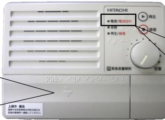
電池切れの場合は、「電源/電池切れ」のランプが赤く点滅します。
